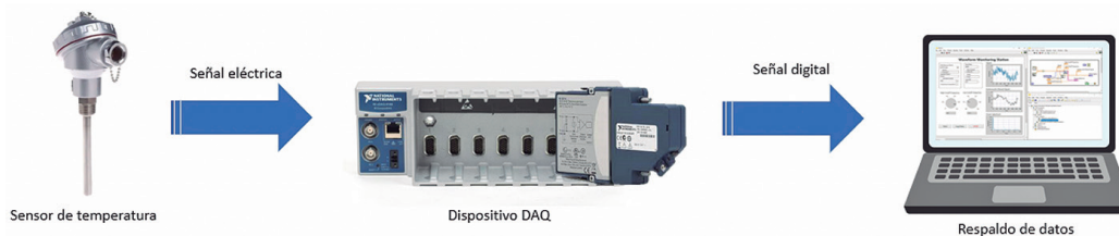
Figura 3. Estructura de un sistema de adquisición y registro de datos (Fuente: Autores). Figure 3. Data acquisition and recording system structure (Source: Authors).
