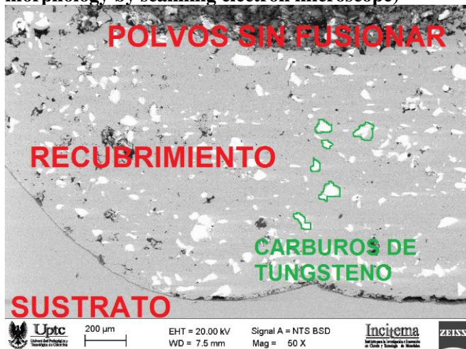
Figura 4. Morfología recubrimiento por medio de microscopio electrónico de barrido. (Coating morphology by scanning electron microscope)
