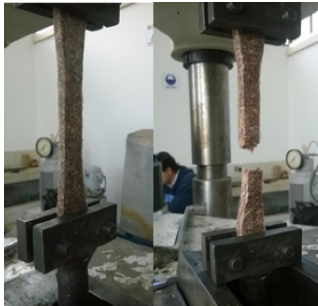
Figura 2. Ensayo de resistencia a la tracción. Figure 2. Tensile strength test.
